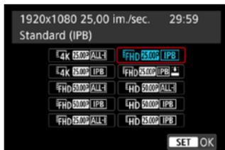
Sous l'onglet [📷 1 : Qualité enr vidéo], sélectionnez [Taille enr. vidéo] pour régler la taille d'image, la cadence d'enregistrement des images et la méthode de compression. La vidéo sera enregistrée en tant que fichier MP4. La cadence d'enregistrement des images affichées sur l'écran [Taille enr. vidéo] change automatiquement selon le réglage [🔧 3 : Système vidéo] (p. 384).
