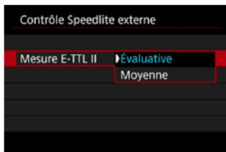
Pour des expositions au flash normales, réglez cette option sur **[Évaluative]**. Si **[Moyenne]** est sélectionné, l'exposition au flash est calculée selon une moyenne pour l'ensemble de la scène mesurée. Selon la scène, la correction d'exposition au flash peut être nécessaire. Ce réglage est destiné aux utilisateurs avancés.
