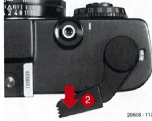
effectuée que lorsque l'obturateur de l'appareil est **armé** et le levier d'armement rapide (2) légèrement tourné (environ 20°) à partir de sa position de repos. Après le déclenchement, il est possible que l'aiguille dans le viseur dévie un peu, mais la mesure est cependant impossible.
