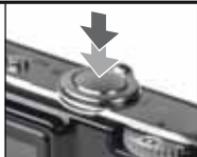
Faites la mise au point du sujet, enfoncez le déclencheur à mi-course
