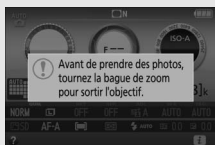
Commande de déverrouillage de l'objectif rétractable
