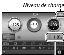
Niveau de charge
