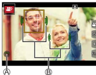
\*1 Lorsque le [Microphone intégré] est sur ([AUTO]) ou ([TRACKING]) et qu'un visage est reconnu par ([Détection visage/œil]), l'appareil photo affiche automatiquement la cible de collecte du son en fonction de l'état du sujet.
