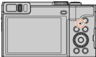
Allumé : Lorsque la fonction Wi-Fi est activée ou en cas de connexion Wi-Fi
