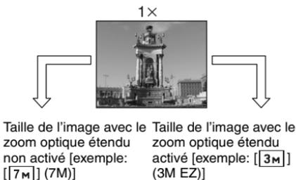
**■ Mécanisme du zoom optique étendu**
