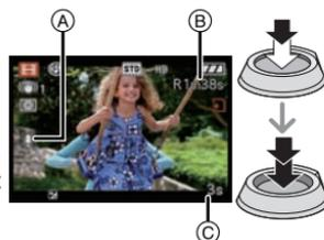
**5** Appuyez à fond sur le déclencheur pour arrêter l'enregistrement.
