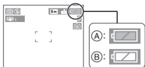
**(A) : Lorsque des piles Oxyride sont sélectionnées**
