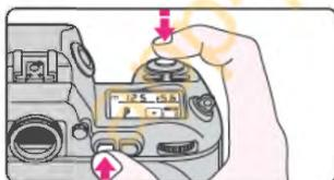
• Lorsque la commande
