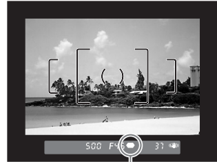
Témoin de mise au point
