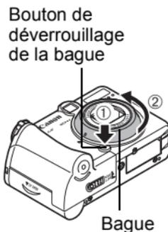
**3** Lorsque la marque ● située sur la bague et la marque ○ située sur l'appareil photo sont alignées, soulevez la bague pour la retirer.
